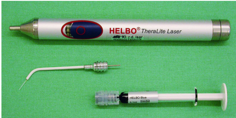
Abbildung 3 Medizinischer Diodenlaser ( \lambda = 660 \text{ nm} ) HELBO Theralite Laser, Firma HELBO Medizintechnik GmbH, Wels, Österreich.
